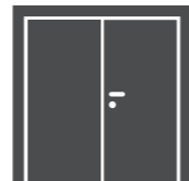
porta a due ante simmetriche door with two symmetrical leaves porte à 2 battantes symétriques двустворчатая симметричная дверь drzwi z 2 symetrycznymi skrzydłami puerta con 2 hojas simétricas
